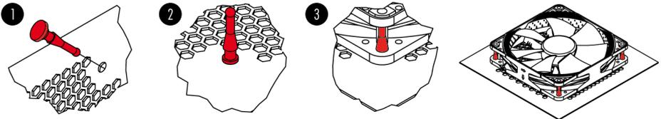
Falls erforderlich, können Sie die integrierten Anti-Vibrations Pads des NF-A14 PWM einfach entfernen:
