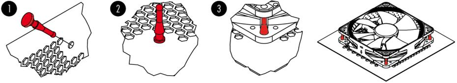
Si resultara necesario, puede quitar los paneles anti-vibración integrados del NF-A8 FLX fácilmente:
