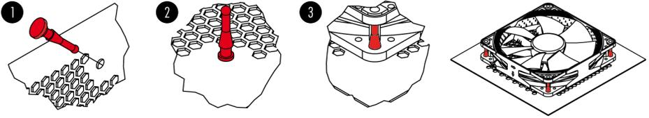
Si resultara necesario, puede quitar los paneles anti-vibración integrados del NF-S12A ULN fácilmente:
