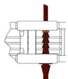
**Attention:** Etirez l'attache au travers du trou jusqu'au cran 1 uniquement. Veillez à ne pas trop étirer les attaches de fixation en faisant passer le cran 5 au travers du trou opposé !
