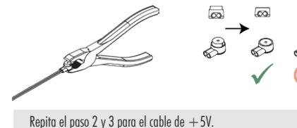
Una vez los cables del ventilador original estén unidos a los del adaptador OmniJoin a través de conectores Skotchlok no hay más que conectar el
