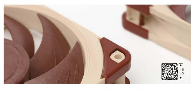
NF-A12x25是一款高度优化的新一代120mm风扇,它集成了Noctua在空气动力学工程领域的领先创新成果,以实现前所未有的安静、冷却性能水平。它采用很先进的技术,如AAO(先进声学优化)框架或流量加速通道,并将它们与创纪录的仅0.5mm的 尖端间隙相结合,这是通过使用新型Sterrox ® - 结晶聚合物(LCP)化合物以及金属增强型马达轮毂和轴,才实现的高度 精准。继Noctua的A系列产品之后,NF-A12x25是一款真正的全能型产品,无论是低阻抗,面向气流的应用(例如机箱冷却)还是高性能产品阻抗,压力要求较高的场景,如散热器和水冷散热器。4针引脚PWM型号支持通过PWM风扇接头进行全自动速度、控制,并配有低噪声适配器,可将上限速度从2000rpm降至1700rpm。 NF-A12x25具有卓越的运行平稳性,配合Noctua的参考级SSO2轴承,丰富的配件和6年制造商保修,NF-A12x25无疑是一款高品质的产品。其卓越的效率,尖端的构造和开拓性材料使其成为挑剔的需求精英者的更好选择。
