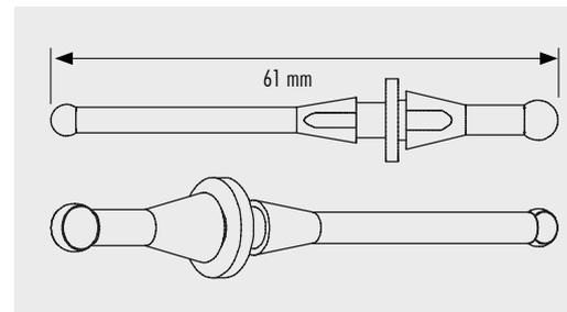
**Achtung** Die NA-AV2 Befestigungen sind mit allen Noctua Lüftern sowie Lüftern anderer Hersteller kompatibel, die über Standard-Montagelöcher mit 4,3mm Durchmesser sowie offene Flanschen verfügen.
