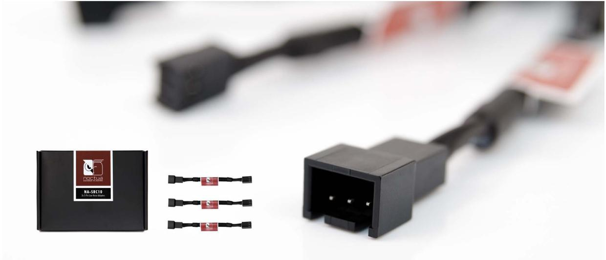
Le NA-SRC10 est un kit optionnel pour ventilateur composé de trois adaptateurs faible bruit NA-RC10 entièrement pré-gainés et dédiés aux ventilateurs Noctua 3-broches. Branchés entre la source de courant et le ventilateur, les adaptateurs réduisent la vitesse de rotation ainsi que les émissions sonores. Le NA-SRC10 est idéal pour ralentir la vitesse des ventilateurs Noctua de la série Redux (voir tableau de vitesses).
