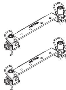
**Precaución:** El kit NM-i4189 es compatible únicamente con los disipadores de las series DX-3647 y TR4-SP3, pero no puede utilizarse con ningún otro disipador Noctua.
