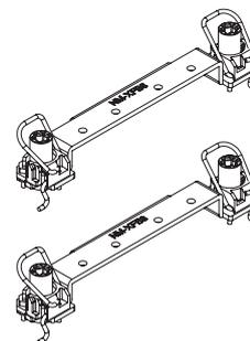
**Attention :** Le NM-i4189 n'étant compatible qu'avec les ventilads DX-3647 et ceux de la série TR4-SP3, il ne peut donc être utilisé avec d'autres ventilads Noctua.
