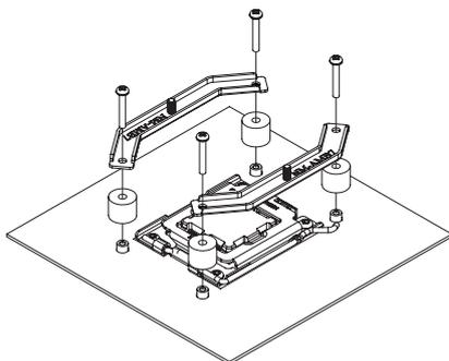
请注意，这款 NM-AM5/4-MP78 套件仅与 78mm 安装间距的散热器兼容。对于 83mm 安装间距的散热器，必须使用 NM-AM5/4-MP83 安装套件。
