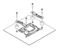
Bitte beachten Sie, dass das NM-AM5/4-MP83 Set ausschließlich mit Kühlern kompatibel ist, die über einen Montageabstand von 78mm verfügen, und dass für Kühler mit 83mm Montageabstand das NM-AM5/4-MP78 Set verwendet werden muss.
