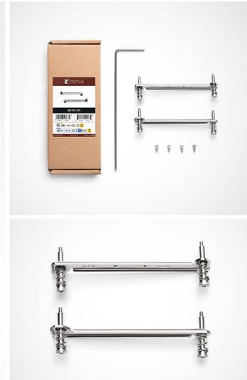
NM-TR5-SP6 是一款 SecuFirm2™ 的安装套件，可将 Noctua 的 DX-4677、DX-4189、DX-3647 和 TR4-SP3 系列散热器安装到适用于 Epyc 系列服务器和 Threadripper 系列工作站的 AMD TR5/SP6 CPU 插槽。虽然支架和弹簧已更新到以满足新 TR5/SP6 插槽增加的压力要求，但安装方式与上一代一样简单：装上散热器，使用随带固定工具，固定四个弹簧加载内六角螺钉，你就完成了！
