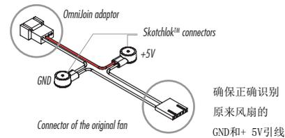
在确定了以上各个潜在的隐患后，请继续通过以下步骤安装OmniJoin™适配器：
