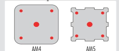
**注意:**散热膏涂抹过多会导致降低其导热性和散热性能!
