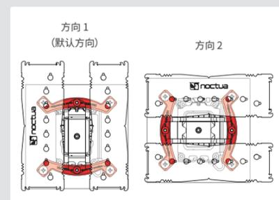
**注意事项：**请确保安装杆弯曲凸起的一侧朝外。
