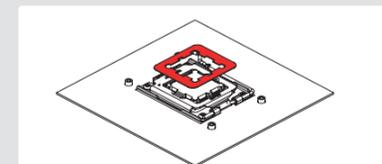
确保散热膏保护贴的内部切口与散热器的外边缘形状正确对齐:
