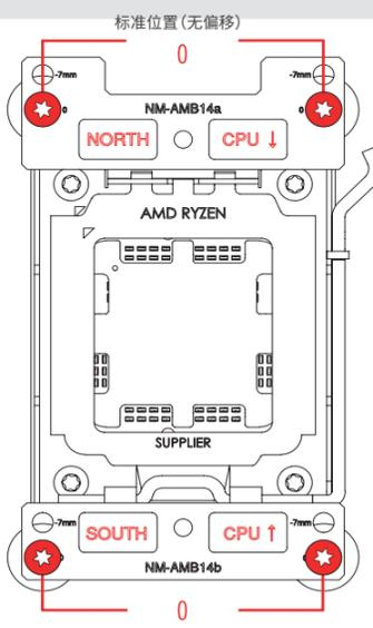
**注意:**如上图所示,确保"CPU→"标记指向CPU,且带有"NORTH"标记的NM-AMB14a安装杆安装在插槽的北侧(顶部),带有"SOUTH"标记的NM-AMB14b安装杆安装在插槽的南侧(底部)。
