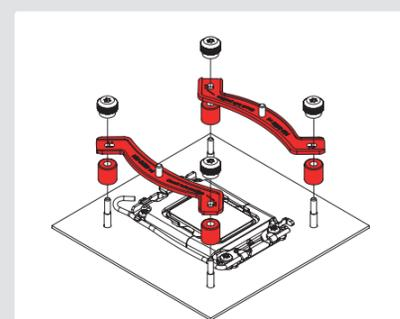
注意：根据散热器所需要的最终方向选择安装杆的对齐方式。
