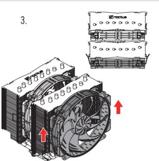
3. 此外,散热器也可仅安装散热塔中间的风扇,以确保与高内存模块的更好兼容性。
