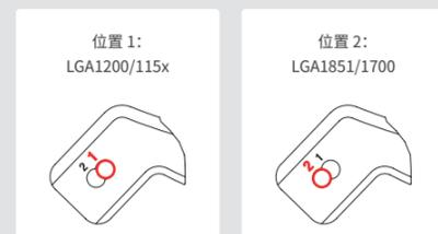
将相应的塑料垫片装到背板的螺栓上，然后装上安装杆。
