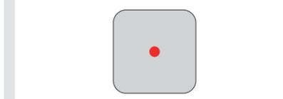
**注意：**散热膏涂抹过多会导致降低其导热性和散热性能
