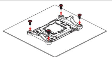
在AM4上,当取下固定模块时,原装背板会松动,因此请在下一步中将其固定住。如果您丢失了原装AM4背板,请通过发邮件至support@yanyi-noctua.com的方式与我们联系。在AM5上,原装背板是用螺丝固定在插槽上,因此只需保持原位即可。
