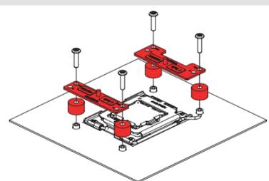
在AM5 CPU和AM4的Ryzen 5000/3000系列CPU上,请选择-7mm偏移孔位置,以确保更理想的接触压力和散热性能。在其他AM4 CPU上,或者如果遇到偏移位置后存在任何的兼容性问题(例如与主板散热部件的间隙冲突)等特殊状况,请选择标准位置(0)。
