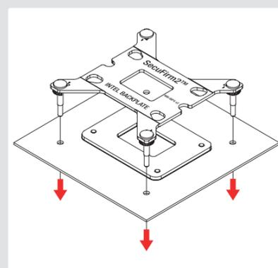
**注意事项：**提供的背板将安装在主板的原装背板上，因此主板的原装背板不得取下。
