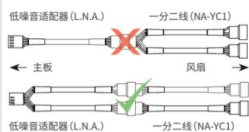
**注意:**使用低噪音适配器(L.N.A.)时,请使用适当的软件(如主板制造商的相应应用程序)检查CPU的温度,以避免CPU因温度升高而自动节流。如果散热性能不足,请增加机箱通风或拆除低噪音适配器(L.N.A.)。
