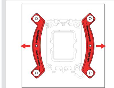
使用4个NM-ST51-TX指旋螺丝固定安装杆
