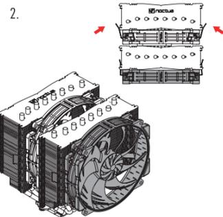
2. 为了增加内存的间隙,前置风扇也可以向上移动。但请注意,这样会使散热器总高度超过168mm。
