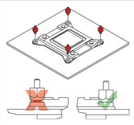
然后将NM-IMB2安装支架放在螺栓上。
