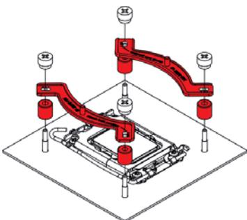
注意：根据您所需要的散热器最终安装方向，选择安装支架的位置。
