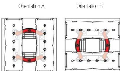
注意：请确保安装支架弯曲凸起的一侧朝外。
