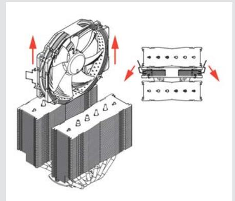
然后将散热器放到CPU上，再将其拧到安装杆的螺纹上。每个螺丝拧动2-3转，然后重复动作，直到两个螺丝完全拧紧为止。
