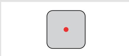
注意：使用过多的散热膏将降低导热性和散热效果。
