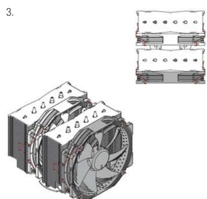
风扇一定得安装在散热器的中间，以确保与有高大散热模块内存的最大兼容性。可以在散热片的前鳍栈增加第二个风扇以进一步提升散热性能。把风扇的连接头连接到主板接头上，如果有需要的话，可以使用附带的NA-YC1 Y型分接电缆连接两个风扇到一个主板接头上。
