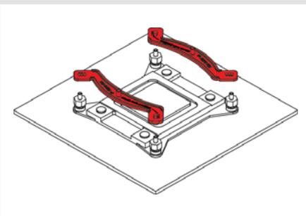
注意：根据您所需要的散热器最终安装方向，选择安装支架的位置。
