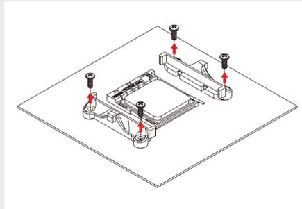
如果您的主板没有预装CPU散热器固定模块，主板应该有附带AMD原始背板。请将背板放在主板的背面，使背板的螺纹穿过主板的安装孔，如下图所示。
