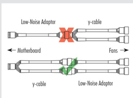
注意：当使用低噪音适配器的时候，为了避免CPU负载过高后温度增加，请使用相关的软件检查您的CPU温度(您的主板制造商有提供)。如果散热效果不是很好，请增加配件透气性或移除(超)低噪音适配器。
