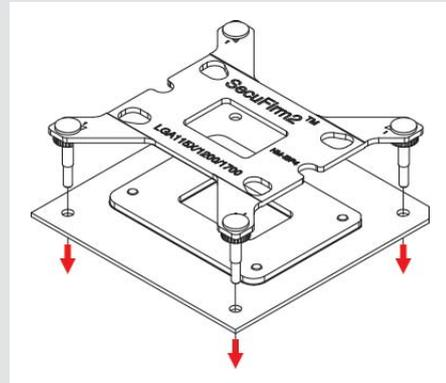
注意：散热器提供的背板将安装在原主板的背板上，因此切勿取下原主板的背板。
