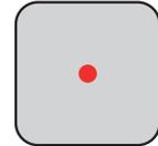
注意：使用过多的散热膏将降低导热性和散热效果。
