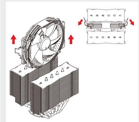
然后将散热器放到CPU上，再将其拧到安装杆的螺纹上。
