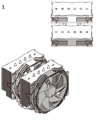
第一个风扇请安装在散热器的中间，如安装较高的内存时，可以确保不会与内存产生兼容性的问题。
