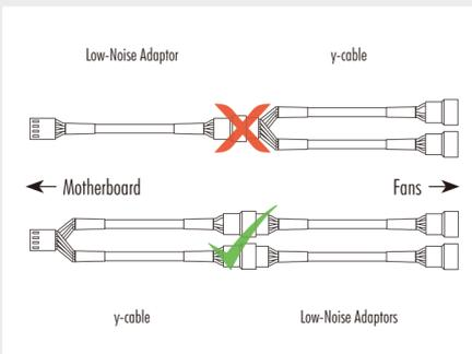
注意：当使用低噪音适配器的时候，为了避免CPU负载过高后温度增加，请使用相关的软件检查您的CPU温度(您的主板制造商有提供)。
