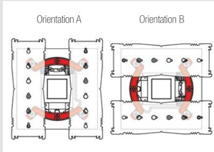
注意：请确保安装支架弯曲凸起的一侧朝外。
