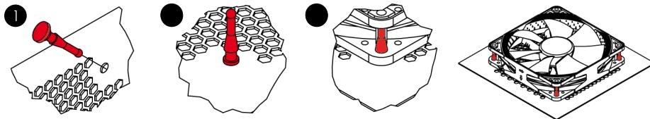
如果有必要需移除NF-A8 ULN的综合性防振垫，你可以很容易的移除。
