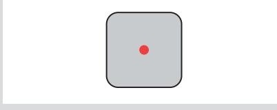
注意：使用过多的散热膏将降低导热性和散热效果。
