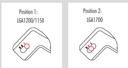
注意：请确保NM-IMB3安装条的两端安装在正确的孔位置，以免无法对齐。
