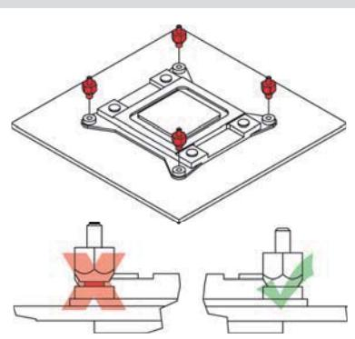
然后将NM-IMB3安装支架放在螺栓上。
