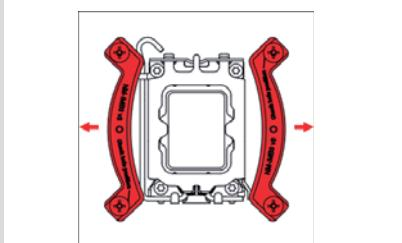
使用4个NM-ITS1指旋螺丝固定安装支架。
