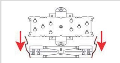
然后将散热器放到CPU上，然后将其拧到安装杆的螺纹上。每个螺丝拧动2-3转，然后重复动作，直到两个螺丝完全拧紧为止。
