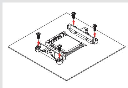
如果您的主板没有预装CPU散热器固定模块，主板应该有附带AMD原始背板。
