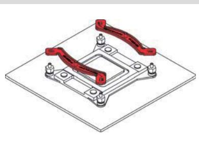
注意：根据您所需要的散热器最终安装方向，选择安装支架的位置。
