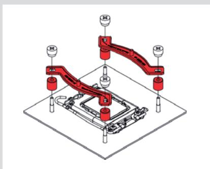
注意：根据您所需要的散热器最终安装方向，选择安装支架的位置。
