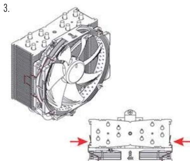
将风扇插到主板的CPU风扇插头上。根据你的CPU和机箱内的温度，您可以使用所提供的NA-RC7低噪音适配器(L.N.A.)以进一步降低风扇的运行噪音。
