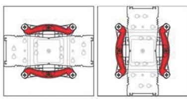
注意：请确保安装支架弯曲凸起的一侧朝外。
