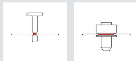
Tenga en cuenta que en algunos modelos más estrechos de ventiladores, y dependiendo del modo en el que se instala el mismo ventilador, los pasadores podrían no sujetar con firmeza. En tal caso, utilice los tornillos para instalar las rejillas.
