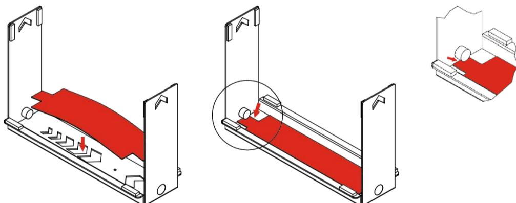
**4** Deslice las cubiertas sobre los conjuntos de aletas hasta que los imanes estén colocados en su lugar. Compruebe que las cubiertas están bien sujetas al disipador.
