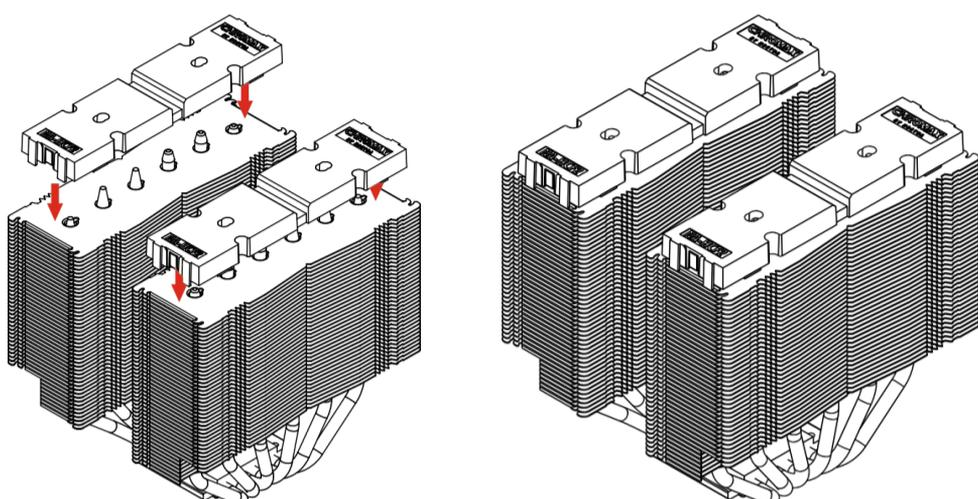
**2** Fíjelas a los mismos utilizando los clips metálicos. Tenga en cuenta que los clips metálicos deben colocarse por debajo de la segunda aleta desde la parte superior.
