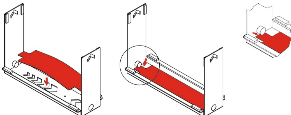
**4** Faites glisser les habillages sur les blocs à ailettes jusqu'au verrouillage des aimants. Assurez-vous que les habillages sont fermement positionnés sur le ventirad.
