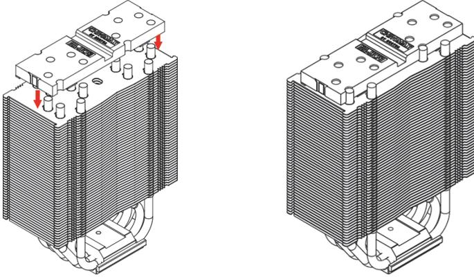
**2** 使用钢夹将固定夹固定在散热器上。
