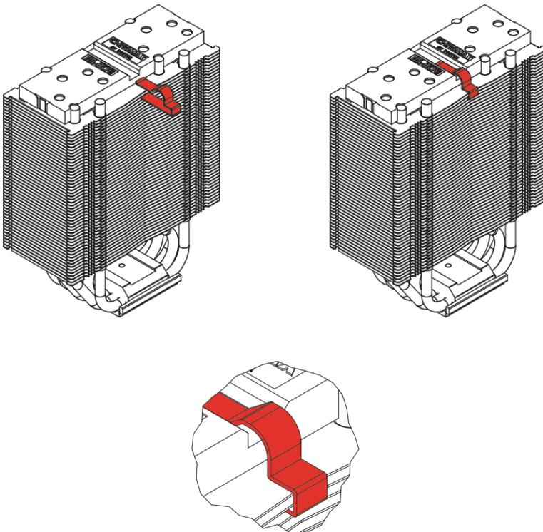
请注意，钢夹必须位于从顶部算起的第二个翅片的下方。
