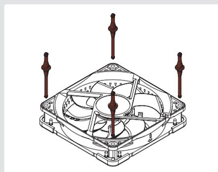
Después, tire del lateral C a través de los orificios de montaje del dispositivo.
