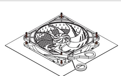
如果支架的长度妨碍了您安装，您可以在安装后用剪刀将其剪掉。请注意，这将使它们在以后难以重新安装。如果您更喜欢带有扁平外壳侧端的防振支架，请购买我们适配的 NA-AV4 支架。
