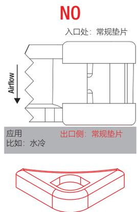
**注意：**不要将散热器螺丝拧得太紧！所有 4 个螺丝上的总压缩负载不得超过 30 公斤（相当于典型 M3 或 UNC 6-32 螺丝的 ~0.15 - 0.25Nm 扭矩）。使用 M4 或细螺纹时要特别小心，因为它们会在较低的扭矩下产生更高的压缩负载。
