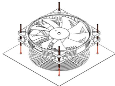
**3** Wenn Sie die langen Enden der Befestigungsstifte stören, können Sie diese nach der Montage mit einer Schere abschneiden.
