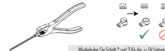
Nachdem Sie das Kabel des ursprünglichen Lüfters mit den Kabelverbindern an den OmniJoin Adapter befestigt haben, können Sie den NF-A20 5V einfach an den Adapter anstecken, um ihn in Ihrem Gerät zu verwenden.
