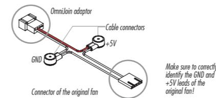
Nachdem Sie die einzelnen Leitungen identifiziert haben, führen Sie die folgenden Schritte durch, um den OmniJoin Adapter zu installieren:
