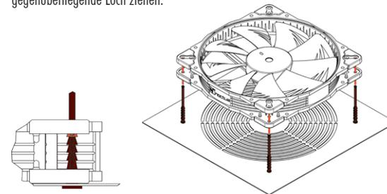
Wenn Sie die langen Enden der Befestigungsstifte stören, können Sie diese nach der Montage mit einer Schere abschneiden.
