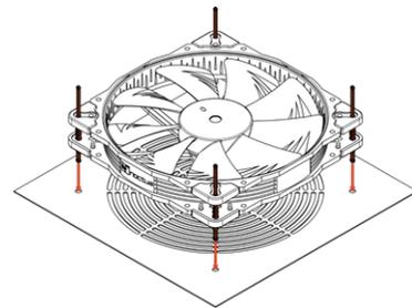
Zur Montage des Lüfters mit den **NA-AV4** Befestigungen:
