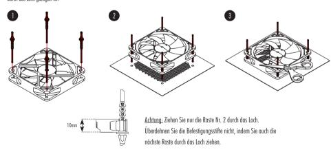
Ziehen Sie anschließend die C-Seite durch die Montagelöcher des Gehäuses. Wenn Sie die langen Enden der Befestigungsstifte stören, können Sie diese nach der Montage mit einer Schere abschneiden. Beachten Sie jedoch, dass eine neuerliche Montage mit abgeschnittenen Enden deutlich schwieriger ist.
