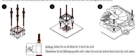
Ziehen Sie anschließend die C-Seite durch die Montagelöcher des Gehäuses. Wenn Sie die langen Enden der Befestigungsstifte stören, können Sie diese nach der Montage mit einer Schere abschneiden. Beachten Sie jedoch, dass eine neuerliche Montage mit abgeschnittenen Enden deutlich schwieriger ist.
