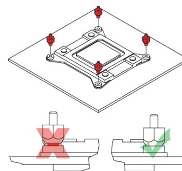
Posteriormente, coloque las barras de montaje NM-IMB2 en los tornillos.
