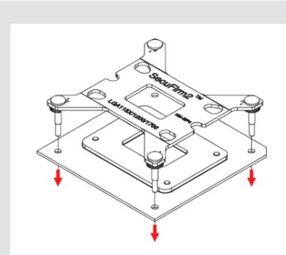
Coloque la placa de soporte en la parte trasera de la placa base de forma que los tornillos sobresalgan a través de los orificios de montaje.
