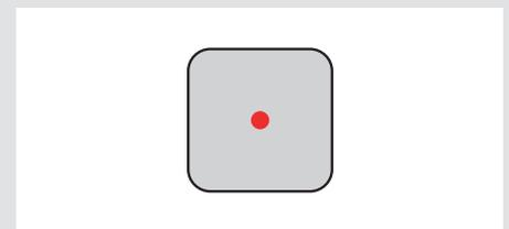
**Precaución:** Aplicar demasiada pasta térmica reducirá la conductividad del calor y el rendimiento de refrigeración.
