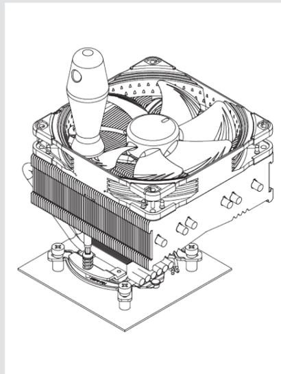
**Precaución:** Apriete los tornillos con cuidado hasta que se detengan, sin aplicar demasiada fuerza (max. par de fuerza 0.6 Nm).
