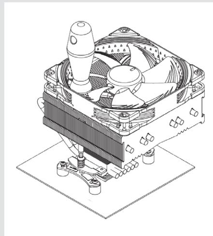
**Precaución:** Apriete los tornillos con cuidado hasta que se detengan, sin aplicar demasiada fuerza (max. par de fuerza 0.6 Nm).
