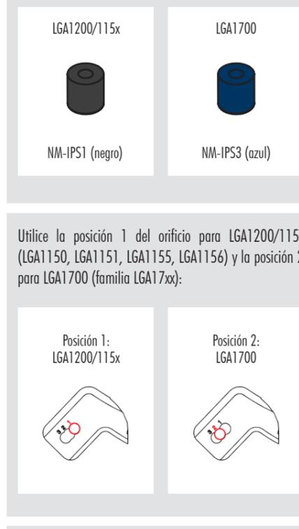
Introduzca los separadores de plástico en los tornillos de la placa de soporte, después incorpore las barras de montaje.
