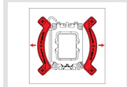
Sujete las barras de montaje con los 4 tornillos de ajuste manual.
