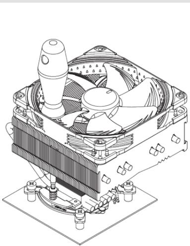
**Attention :** Il est important de serrer normalement, et sans excès, les vis jusqu'à leur arrêt (max. torque 0,6 Nm).
