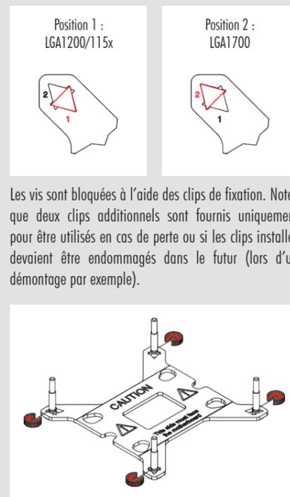
Les vis sont bloquées à l'aide des clips de fixation. Notez que deux clips additionnels sont fournis uniquement pour être utilisés en cas de perte ou si les clips installés devaient être endommagés dans le futur (lors d'un démontage par exemple).
