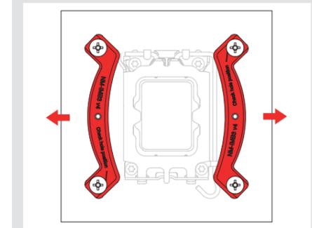
Fixieren Sie die Montagebrücken mit den 4 NM-ST51 Rändelschrauben.
