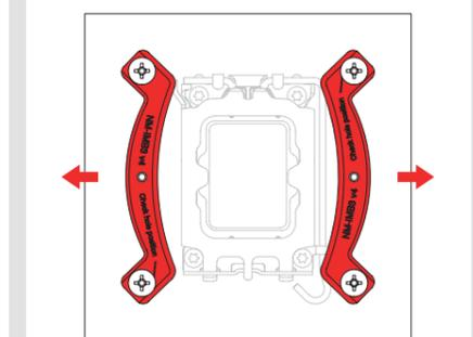
Fixieren Sie die Montagebrücken mit den 4 NM-ITS1 Rändelschrauben.
