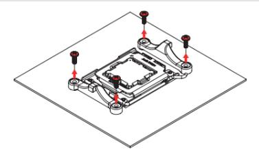
Auf AM4 wird sich die serienmäßige Backplate beim Abschrauben des Haltmoduls lösen, halten Sie sie daher für den nächsten Schritt fest. Wenn Sie Ihre AM4-Backplate verloren haben, kontaktieren Sie uns bitte unter [support@noctua.at](mailto:support@noctua.at). Auf AM5 ist die serienmäßige Backplate mit dem Sockel verschraubt.
