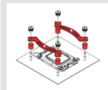
Attention : Il est important d'aligner les étriers de fixation en fonction de l'orientation finale souhaitée du radiateur.
