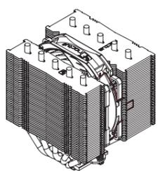
ventilateur NF-A12x25r se trouvera nécessairement au dessus des modules mémoire ou bien au niveau du panneau de connectique arrière pour une hauteur totale dépassant ainsi les 145 mm. Il est de fait important de vérifier l'espace disponible au sein de votre boîtier pour vous assurer qu'un deuxième ventilateur peut y être installé. Par exemple, si vos modules de RAM ont une hauteur de 50 mm, vous aurez besoin d'un espace libre de 170 mm (50 mm pour la RAM + 120 mm pour le ventilateur).
