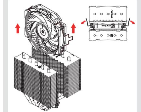
Positionnez à présent le ventilad sur le CPU et fixez celui-ci sur les filetages présents sur les étriers de montage. Commencez le serrage des vis en effectuant 2-3 tours de tourne-vis pour chacune d'elle puis répétez l'opération jusqu'à ce que les deux vis soient totalement serrées.
