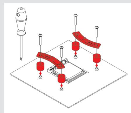
**Achtung:** Stellen Sie sicher, dass die Biegungen der Montagebrücken nach innen zeigen.
