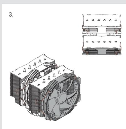
Um beste Kompatibilität mit hohen Speichermodulen zu erreichen, verwenden Sie den Kühler nur mit dem zentralen Lüfter. Montieren Sie den zweiten Lüfter am vorderen Kühlblock, um noch bessere Kühlleistung zu erzielen.
