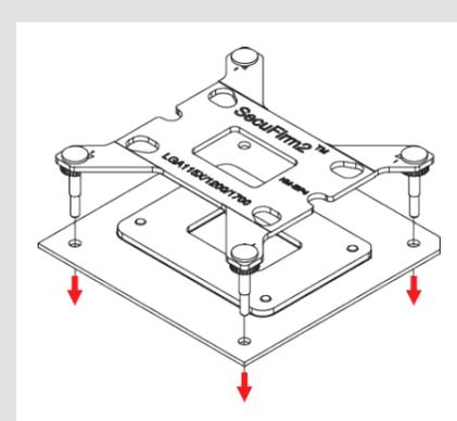
**Achtung:** Die ab Werk am Mainboard verbaute Backplate darf nicht abgenommen werden. Die Backplate des Kühlers wird über der Backplate des Mainboards installiert.
