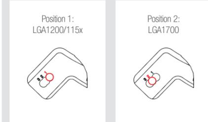
**Achtung:** Verwenden Sie unbedingt an beiden Enden der Montagebrücken die korrekte Lochposition, um eine versetzte Montage zu vermeiden.
