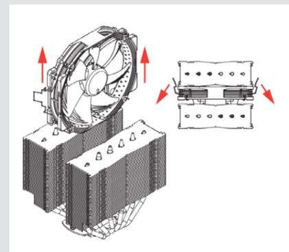
Setzen Sie anschließend den Kühler auf die CPU und schrauben Sie ihn an die Schraubenstützen der Montagebrücken. Führen Sie jeweils 2-3 Umdrehungen pro Schraube aus und wechseln Sie zwischen den Schrauben hin und her, bis beide vollständig angezogen sind.
