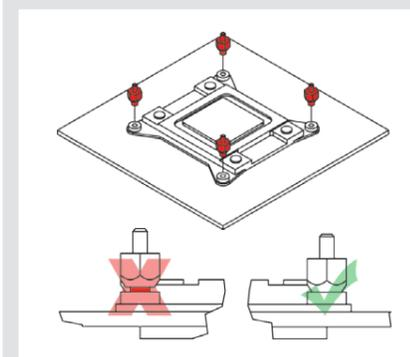
Setzen Sie nun die NM-IMB2 Montagebrücken auf die Bolzen.
