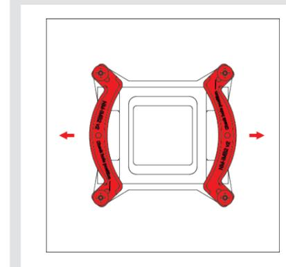
Fixieren Sie die Montagebrücken mit den 4 NM-ITS1 Rändelschrauben.
