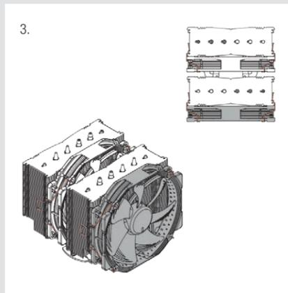
Um beste Kompatibilität mit hohen Speichermodulen zu erreichen, verwenden Sie den Kühler nur mit dem zentralen Lüfter. Montieren Sie den zweiten Lüfter am vorderen Kühlblock, um noch bessere Kühlleistung zu erzielen. Schließen Sie den bzw. die Lüfter am CPU-Lüfteranschluss bzw. den entsprechenden Anschlüssen Ihres Mainboards an. Bei Bedarf verwenden Sie das mitgelieferte NA-YC1 Y-Kabel, um beide Lüfter an einem Anschluss zu betreiben.
