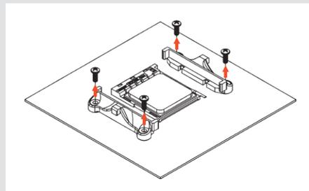
Falls auf Ihrem Mainboard kein Retention-Modul vormontiert ist, sollten Sie mit dem Mainboard-Zubehör eine originale AMD-Backplate erhalten haben. Setzen Sie die Backplate so auf die Rückseite des Mainboards, dass die Gewindestutzen der Backplate wie unten dargestellt durch die Montagelöcher des Mainboards ragen. Falls bei Ihrem Mainboard keine Backplate vormontiert oder mitgeliefert sein sollte, kontaktieren Sie bitte unser Support-Team [support@noctua.at](mailto:support@noctua.at).
