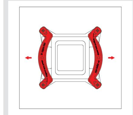
Fije las barras de montaje empleando los cuatro tornillos manuales.
