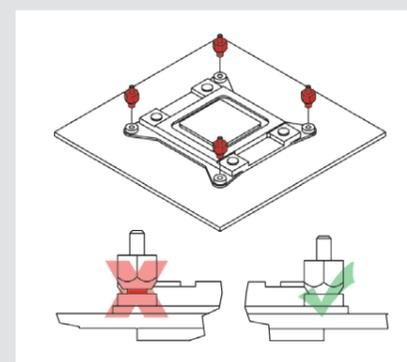
Posteriormente, coloque las barras de montaje NM-IMB2 en los tornillos.
