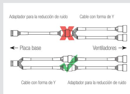
**Precaución:** Cuando utilice el adaptador L.N.A., compruebe la temperatura de su CPU utilizando un software apropiado (p.ej., las respectivas aplicaciones del fabricante de su placa base) con el fin de evitar el funcionamiento irregular de la CPU debido al aumento de la temperatura. Si el rendimiento de refrigeración es insuficiente, aumente la ventilación de la caja o retire el adaptador L.N.A.
