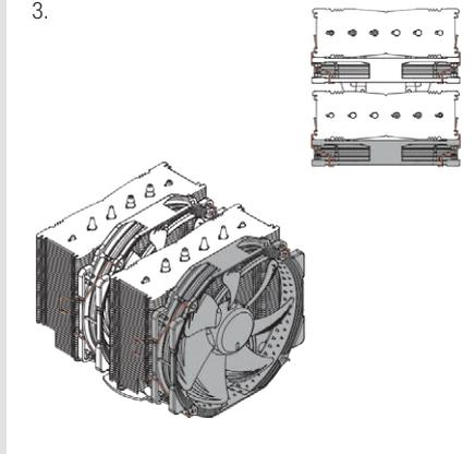
Utilice el disipador únicamente con el ventilador central para garantizar la mejor compatibilidad con los módulos RAM altos. Coloque el segundo ventilador en la parte frontal del conjunto de aletas para obtener un mayor rendimiento de refrigeración.
