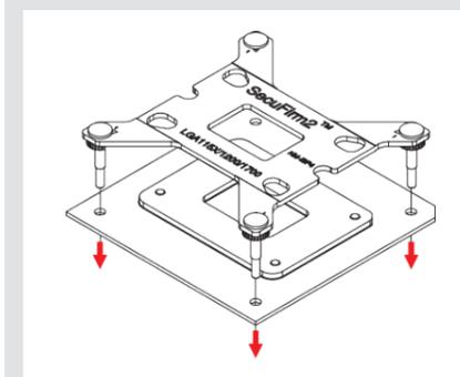
**Precaución:** La placa de soporte que se incluye se instalará sobre el soporte de la placa base, por lo que este último soporte no deberá retirarse.
