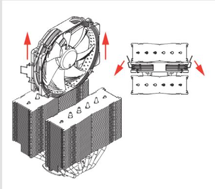
Coloque a continuación el disipador sobre la CPU y atornillelo a los orificios de las barras de montaje. Dé 2-3 vueltas en cada tornillo, después repita la operación hasta que ambos estén completamente apretados.
