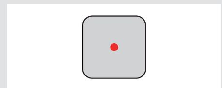
**Precaución:** Aplicar demasiada pasta térmica reducirá la conductividad del calor y el rendimiento de refrigeración.
