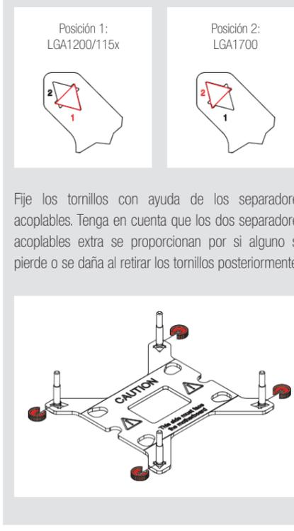
Fije los tornillos con ayuda de los separadores acoplables. Tenga en cuenta que los dos separadores acoplables extra se proporcionan por si alguno se pierde o se daña al retirar los tornillos posteriormente.
