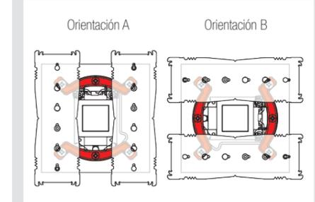
**Precaución:** Compruebe que los lados curvados de las barras de montaje estén orientados hacia afuera.
