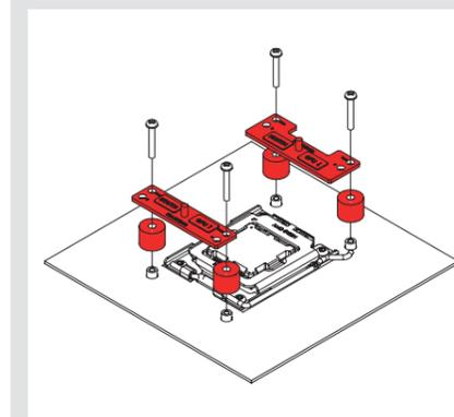
Wählen Sie für AM5 und AM4 CPUs der Serien Ryzen 5000/3000 die versetzte Lochposition von -7mm, um eine optimale Kontaktqualität und Leistung zu gewährleisten.
