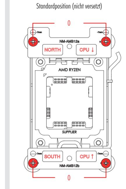
**Achtung:** Stellen Sie sicher, dass die "CPU→"-Markierungen zur CPU zeigen und dass die NM-AMB12a Montagebrücke mit der Markierung "NORTH" auf der nördlichen (oberen) Seite des Sockels und die NM-AMB12b Montagebrücke mit der Markierung "SOUTH" auf der südlichen (unteren) Seite des Sockels installiert wird, wie oben gezeigt.
