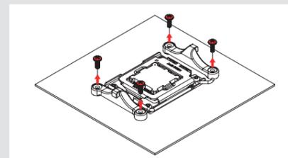
Auf AM4 wird sich die serienmäßige Backplate beim Abschrauben des Haltmoduls lösen, halten Sie sie daher für den nächsten Schritt fest. Wenn Sie Ihre AM4-Backplate verloren haben, kontaktieren Sie uns bitte unter [support@noctua.at](mailto:support@noctua.at). Auf AM5 ist die serienmäßige Backplate mit dem Sockel verschraubt.
