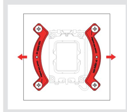
Fixieren Sie die Montagebrücken mit den 4 NM-ITS1 Rändelschrauben.
