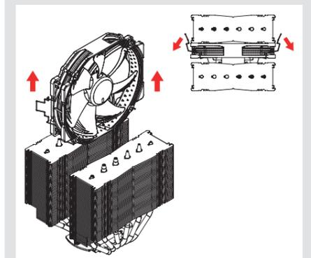
Setzen Sie anschließend den Kühler auf die CPU und schrauben Sie ihn an die Schraubenstützen der Montagebrücken. Führen Sie jeweils 2-3 Umdrehungen pro Schraube aus und wechseln Sie zwischen den Schrauben hin und her, bis beide vollständig angezogen sind.
