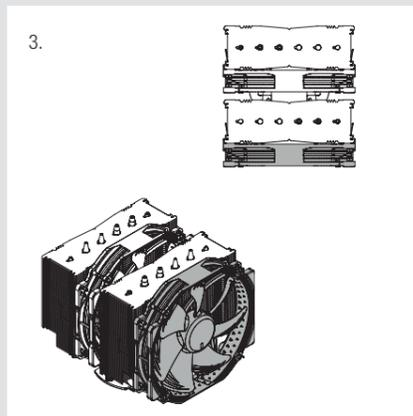
Um beste Kompatibilität mit hohen Speichermodulen zu erreichen, verwenden Sie den Kühler nur mit dem zentralen Lüfter. Montieren Sie den zweiten Lüfter am vorderen Kühl-block, um noch bessere Kühlleistung zu erzielen.
