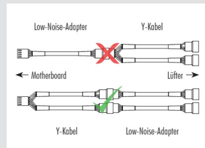
**Achtung:** Überprüfen Sie bei der Verwendung der L.N.A. die Temperatur Ihrer CPU mittels entsprechender Software (z.B. der entsprechenden Applikation Ihres Mainboard-Herstellers), um eine automatische Drosselung der CPU wegen der erhöhten Temperatur zu vermeiden. Falls die Kühlleistung unzureichend sein sollte, erhöhen Sie bitte die Gehäusebelüftung oder entfernen Sie die L.N.A.
