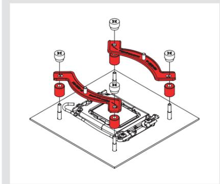
**Achtung:** Wählen Sie die Ausrichtung der Montagebrücken gemäß der gewünschten Orientierung des Kühlers.
