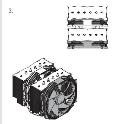
Optez pour un montage avec uniquement le ventilateur central afin d'assurer une compatibilité optimale avec les modules de RAM hauts. Ajoutez le deuxième ventilateur sur la batterie à ailettes frontale si vous privilégiez une performance de refroidissement accrue.
