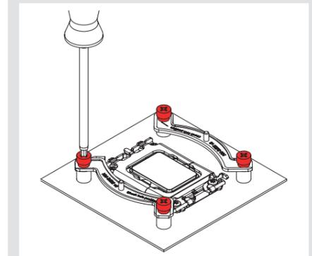
**Attention :** il est important de serrer normalement, et sans excès, les vis jusqu'à leur arrêt (max. torque 0.6 Nm).
