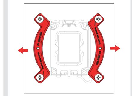
Vissez les étriers de fixation à l'aide des quatre vis à main NM-ITS1.
