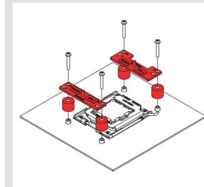
Pour les AM5 et les CPU AM4 des séries Ryzen 5000/3000, sélectionnez le trou correspondant à un décalage de -7mm afin d'optimiser la qualité du contact et les performances.
