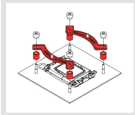
**Attention :** il est important d'aligner les étriers de fixation en fonction de l'orientation finale souhaitée du radiateur.
