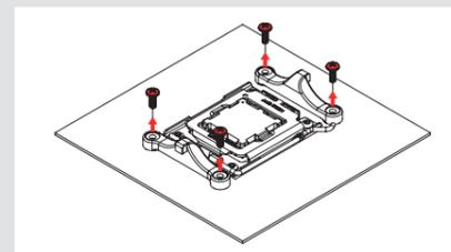
Dans le cas des AM4, le fait de dévisser le module de rétention d'origine nécessitera le maintien manuel de la plaque arrière qui n'est plus retenue. Si vous ne retrouvez pas la plaque arrière de votre AM4, veuillez nous contacter via [support@noctua.at](mailto:support@noctua.at). Pour les AM5, la plaque arrière est vissée au socket et reste donc en place lors de cette opération.
