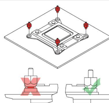
Setzen Sie nun die NM-IMB2 Montagebrücken auf die Bolzen.
