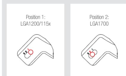
**Achtung:** Verwenden Sie unbedingt an beiden Enden der Montagebrücken die korrekte Lochposition, um eine versetzte Montage zu vermeiden.
