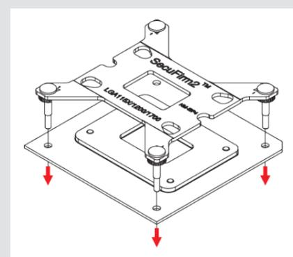
**Achtung:** Die ab Werk am Mainboard verbaute Backplate darf nicht abgenommen werden. Die Backplate des Kühlers wird über der Backplate des Mainboards installiert.
