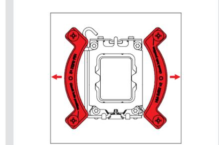
Fixieren Sie die Montagebrücken mit den 4 NM-ITS1 Rändelschrauben.
