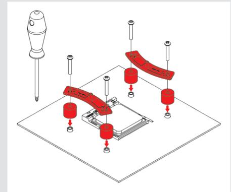
**Achtung:** Stellen Sie sicher, dass die Biegungen der Montagebrücken nach innen zeigen.
