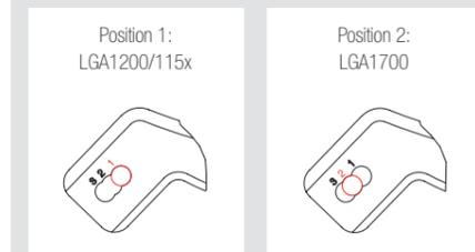
**Achtung:** Verwenden Sie unbedingt an beiden Enden der Montagebrücken die korrekte Lochposition, um eine versetzte Montage zu vermeiden.
