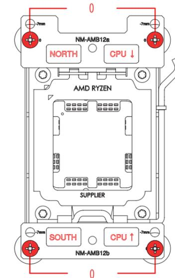
**Achtung:** Stellen Sie sicher, dass die "CPU→"-Markierungen zur CPU zeigen und dass die NM-AMB12a Montagebrücke mit der Markierung "NORTH" auf der nördlichen (oberen) Seite des Sockels und die NM-AMB12b Montagebrücke mit der Markierung "SOUTH" auf der südlichen (unteren) Seite des Sockels installiert wird, wie oben gezeigt.
