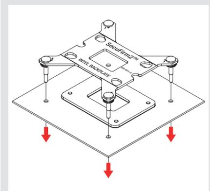
**Achtung:** Die ab Werk am Mainboard verbaute Backplate muss nicht abgenommen werden. Die Backplate des Kühlers wird über der Backplate des Mainboards installiert.
