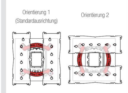
**Achtung:** Stellen Sie sicher, dass die Biegungen der Montagebrücken nach außen zeigen.
