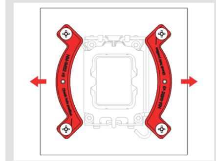
Fixieren Sie die Montagebrücken mit den 4 NM-ITS1s Rändelschrauben.
