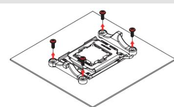
Auf AM4 wird sich die serienmäßige Backplate beim Abschrauben des Haltermoduls lösen, halten Sie sie daher für den nächsten Schritt fest. Wenn Sie Ihre AM4-Backplate verloren haben, kontaktieren Sie uns bitte unter [support@noctua.at](mailto:support@noctua.at). Auf AM5 ist die serienmäßige Backplate mit dem Sockel verschraubt.
