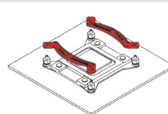
**Precaución:** Escoja la alineación de las barras de montaje de acuerdo con la orientación final que desee para el disipador:
