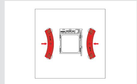
**Precaución:** Apriete los tornillos con cuidado hasta que se detengan, sin aplicar demasiada fuerza (max. par de fuerza 0,6 Nm).
