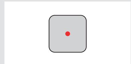
**Precaución:** Aplicar demasiada pasta térmica reducirá la conductividad del calor y el rendimiento de refrigeración.
