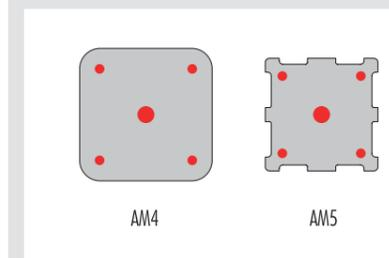
**Precaución:** Aplicar demasiada pasta térmica reducirá la conductividad del calor y el rendimiento de refrigeración.
