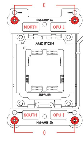
**Precaución:** Compruebe que las marcas "CPU→" apuntan hacia la CPU y que la barra NM-AMB12a con la indicación "NORTH" se instala en el lado norte (superior) del socket; y que la barra NM-AMB12b con la indicación "SOUTH" se instala en el lado sur (inferior) del socket, como se muestra anteriormente.
