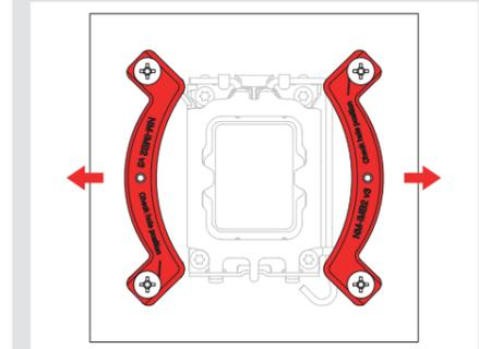
Sujete las barras de montaje con los cuatro tornillos de ajuste manual NM-STS1.
