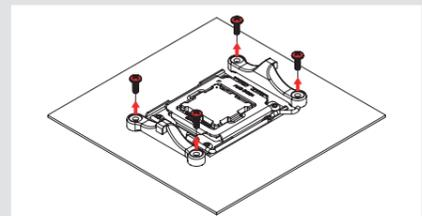
En el caso de AM4, la placa de soporte se afloja al desatornillar el módulo de retención, por lo que tendrá que sujetarla para el siguiente paso. Si ha perdido la placa de soporte AM4, póngase en contacto con nosotros en la siguiente dirección: [support@noctua.at](mailto:support@noctua.at). En el caso de AM5, la placa de soporte se sujeta con tornillos al socket, por lo que, simplemente, permanecerá en su lugar.
