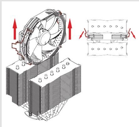
Positionnez à présent le ventilad sur le CPU et fixez celui-ci sur les filetages présents sur les étriers de montage. Commencez le serrage des vis en effectuant 2-3 tours de tournevis pour chacune d'elle puis répétez l'opération jusqu'à ce que les deux vis soient totalement serrées.
