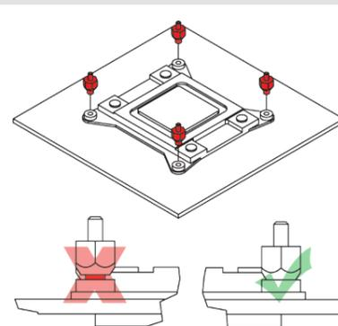
Positionnez à présent les étriers de fixation NM-IMB2 au dessus des boulons.
