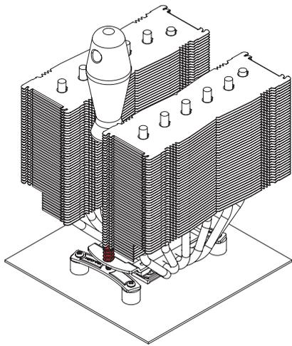
**Attention :** Il est important de serrer normalement, et sans excès, les vis jusqu'à leur arrêt (max. torque 0,6 Nm).
