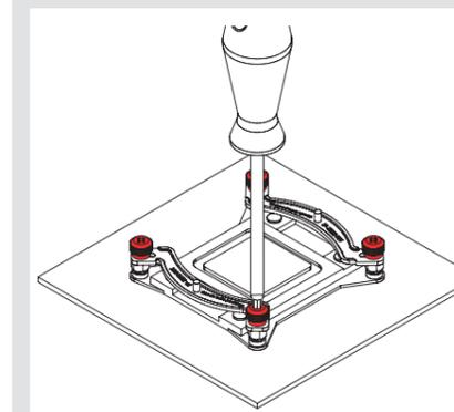
**Attention :** Il est important de serrer normalement, et sans excès, les vis jusqu'à leur arrêt (max. torque 0,6 Nm).
