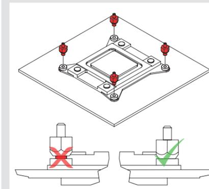
Positionnez à présent les étriers de fixation NM-IMB2 au dessus des boulons.
