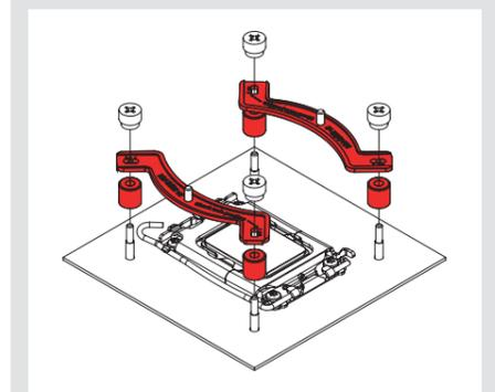
**Attention :** Il est important d'aligner les étriers de fixation en fonction de l'orientation finale souhaitée du radiateur.
