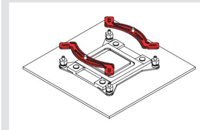
**Attention :** Il est important d'aligner les étriers de fixation en fonction de l'orientation finale souhaitée du radiateur.
