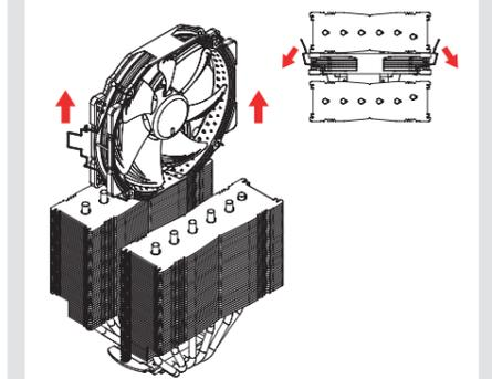
Positionnez à présent le ventilad sur le CPU et fixez celui-ci sur les filetages présents sur les étriers de montage. Commencez le serrage des vis en effectuant 2-3 tours de tournevis pour chacune d'elle puis répétez l'opération jusqu'à ce que les deux vis soient totalement serrées.
