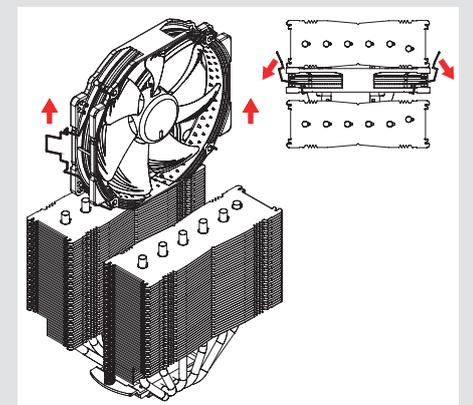
Positionnez à présent le ventilateur sur le CPU et fixez celui-ci sur les filetages présents sur les étriers de montage.
