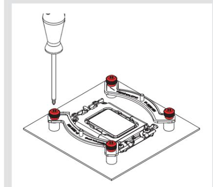
**Attention :** Il est important de serrer normalement, et sans excès, les vis jusqu'à leur arrêt (max. torque 0,6 Nm).
