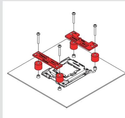
Pour les AM5 et les CPU AM4 des séries Ryzen 5000/3000, sélectionnez le trou correspondant à un décalage de -7mm afin d'optimiser la qualité du contact et les performances.
