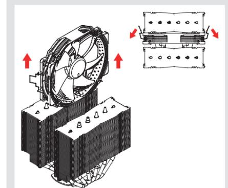
Positionnez à présent le ventirad sur le CPU et fixez celui-ci sur les filetages présents sur les étriers de montage. Commencez le serrage des vis en effectuant 2-3 tours de tournevis pour chacune d'elles puis répétez l'opération jusqu'à ce que les deux vis soient totalement serrées.
