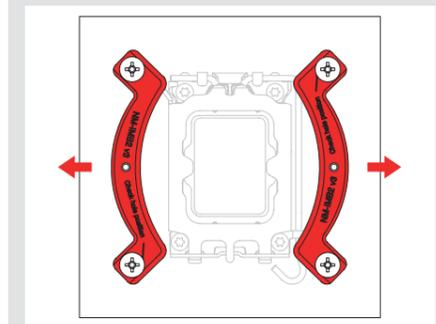
Vissez les étriers de fixation à l'aide des quatre vis à main NM-STS1.
