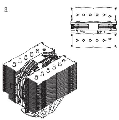
Branchez le(s) ventilateur(s) à un des connecteurs de ventilation situés sur la carte mère. En fonction de votre CPU et de la température au sein de votre boîtier, vous souhaitez peut-être brancher le connecteur L.N.A. (Low-Noise Adapter) NA-RC7 afin de réduire encore les émissions sonores du ventilateur.
