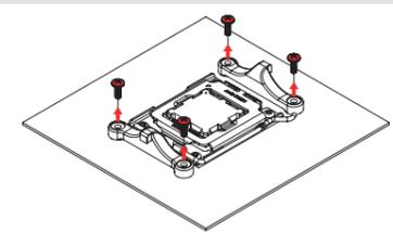
Dans le cas des AM4, le fait de dévisser le module de rétention d'origine nécessitera le maintien manuel de la plaque arrière qui n'est plus retenue. Si vous ne retrouvez pas la plaque arrière de votre AM4, veuillez nous contacter via [support@noctua.at](mailto:support@noctua.at). Pour les AM5, la plaque arrière est vissée au socket et reste donc en place lors de cette opération.
