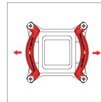
Fije las barras de montaje empleando los cuatro tornillos manuales.
