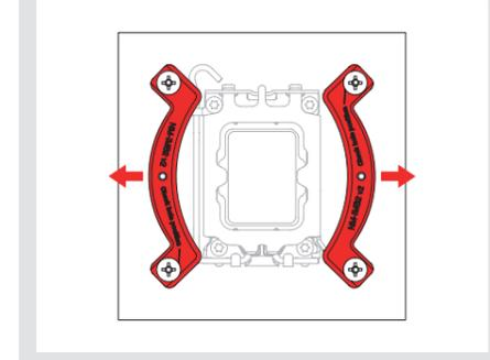
Sujete las barras de montaje con los 4 tornillos de ajuste manual.
