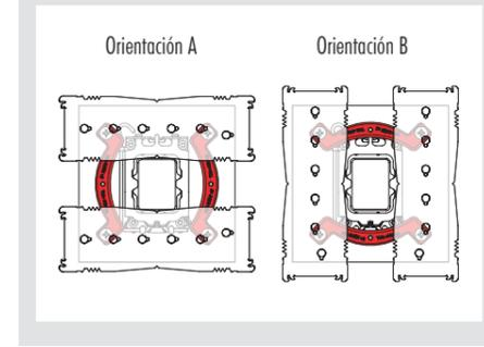
**Precaución:** Compruebe que los lados curvados de las barras de montaje estén orientados hacia afuera.
