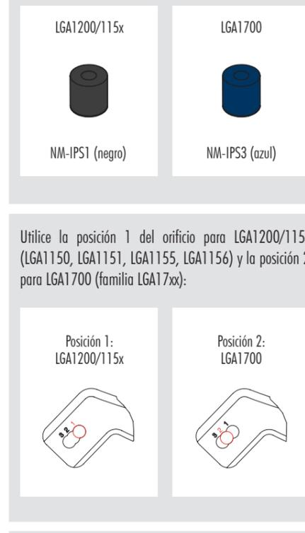
**Precaución:** Compruebe que utiliza la posición correcta del orificio en ambos extremos de las barras de montaje para que estén bien alineadas.
