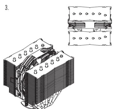
Conecte el ventilador(es) al conector(es) del ventilador de la CPU de la placa base.
