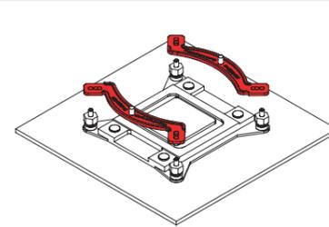
**Precaución:** Escoja la alineación de las barras de montaje de acuerdo con la orientación final que desee para el disipador.
