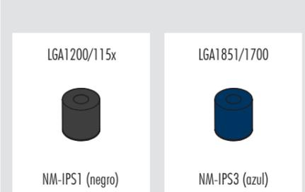
Utilice la posición 1 del orificio para LGA1200/115x (LGA1150, LGA1151, LGA1155, LGA1156) y la posición 2 para LGA1851/LGA1700:
