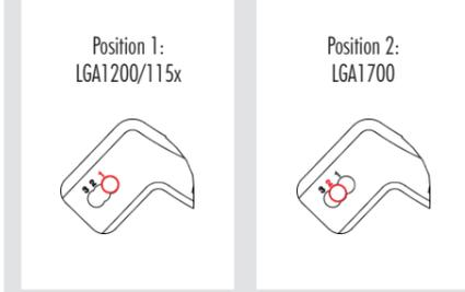
**Achtung:** Verwenden Sie unbedingt an beiden Enden der Montagebrücken die korrekte Lochposition, um eine versetzte Montage zu vermeiden.
