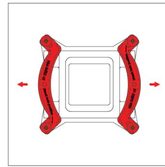
Fixieren Sie die Montagebrücken mit den 4 NM-ITS1 Rändelschrauben.
