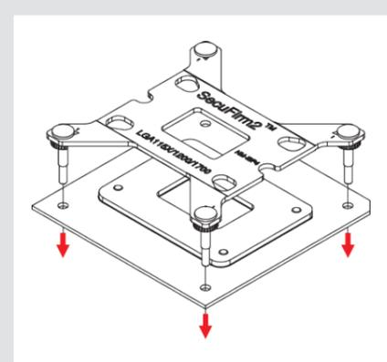
**Achtung:** Die ab Werk am Mainboard verbaute Backplate darf nicht abgenommen werden. Die Backplate des Kühlers wird über der Backplate des Mainboards installiert.
