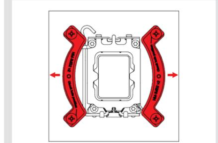
Fixieren Sie die Montagebrücken mit den 4 NM-ITS1 Rändelschrauben.
