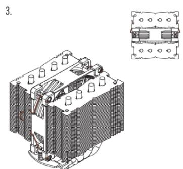
Schließen Sie den Lüfter am CPU-Lüfteranschluss Ihres Mainboards an.
