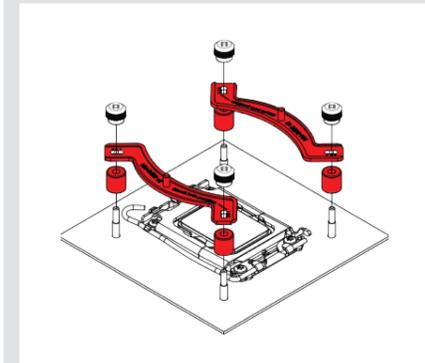
**Achtung:** Wählen Sie die Ausrichtung der Montagebrücken gemäß der gewünschten Orientierung des Kühlers.
