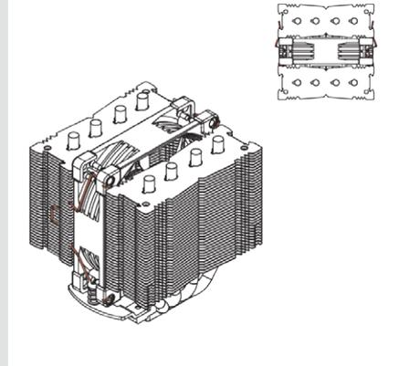
Schließen Sie den Lüfter am CPU-Lüfteranschluss Ihres Mainboards an. Je nach CPU- und Gehäusetemperatur können Sie die mitgelieferten NA-RC7 Low-Noise Adapter (L.N.A.) zwischenschalten, um das Betriebsgeräusch des Lüfters weiter zu reduzieren.
