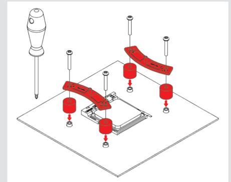
**Achtung:** Stellen Sie sicher, dass die Biegungen der Montagebrücken nach innen zeigen.
