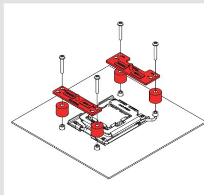
Wählen Sie für AM5 und AM4 CPUs der Serien Ryzen 5000/3000 die versetzte Lochposition von -7mm, um eine optimale Kontaktqualität und Leistung zu gewährleisten.
