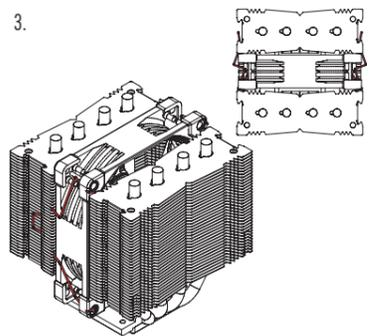
Schließen Sie den Lüfter am CPU-Lüfteranschluss Ihres Mainboards an.
