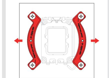
Sujete las barras de montaje con los cuatro tornillos de ajuste manual NM-ITS1.
