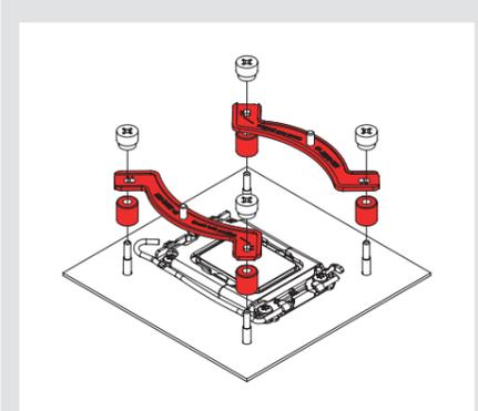
**Precaución:** Elija la alineación de las barras de montaje dependiendo de la orientación final que se desee para el disipador.
