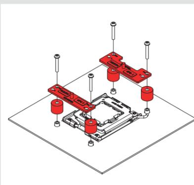
Para los procesadores AM5 y AM4 Ryzen de las series 5000/3000, elija la posición del orificio desplazado -7mm para garantizar un rendimiento y calidad de contacto óptimos.
