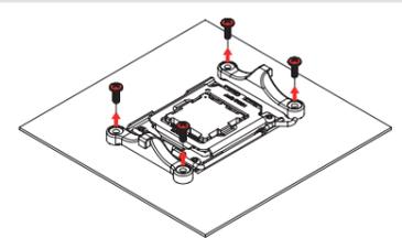
En el caso de AM4, la placa de soporte se afloja al desatornillar el módulo de retención, por lo que tendrá que sujetarla para el siguiente paso. Si ha perdido la placa de soporte AM4, póngase en contacto con nosotros en la siguiente dirección: [support@noctua.at](mailto:support@noctua.at). En el caso de AM5, la placa de soporte se sujeta con tornillos al socket, por lo que, simplemente, permanecerá en su lugar.
