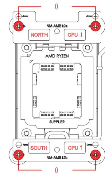
**Precaución:** Compruebe que las marcas "CPU →" apuntan hacia la CPU y que la barra NM-AMB12a con la indicación "NORTH" se instala en el lado norte (superior) del socket; y que la barra NM-AMB12b con la indicación "SOUTH" se instala en el lado sur (inferior) del socket, como se muestra anteriormente.
